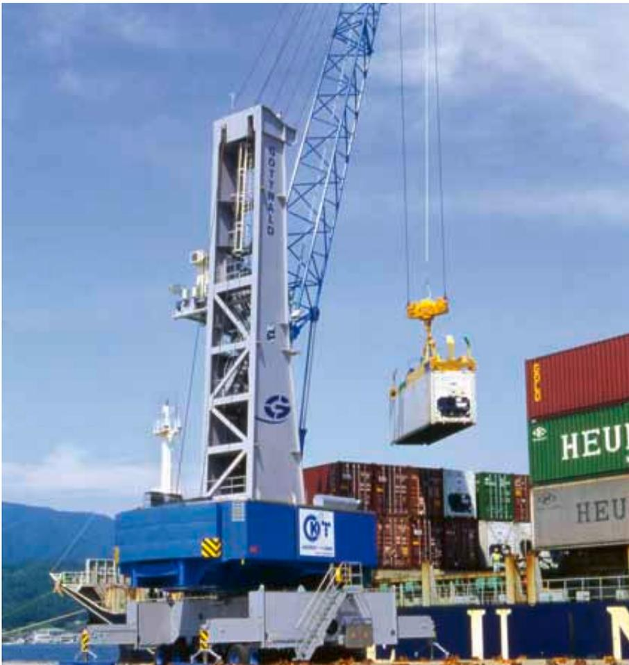
Gottwald Hafenmobilkran HMK 170 E beim Umschlag von Containern in einem Hafen in Japan. Ein vergleichbares Gerät wird im russischen Flusshafen Astrachan Stahl-Coils umschlagen.
