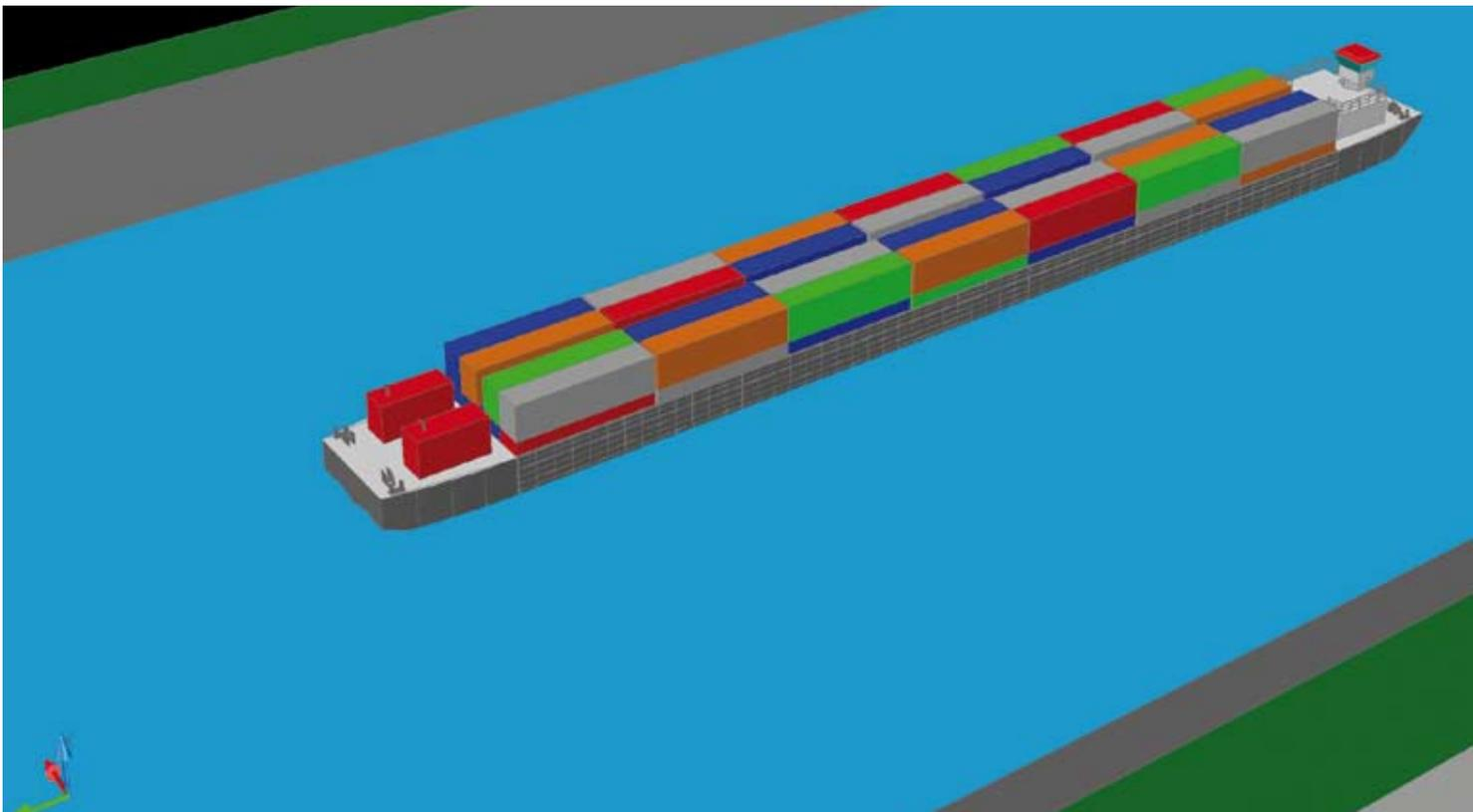
Ansicht von Steuerbord achtern. Die Motoren samt Generatoren sind am Heck in freistehenden Containern untergebracht
