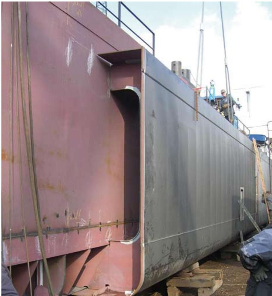
Abb. 3: Montage der Außensektion.
