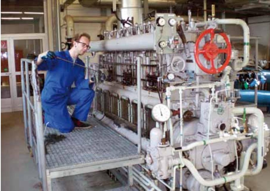
... wie Kontrolle des Ölstandes an der Hauptmaschine.
