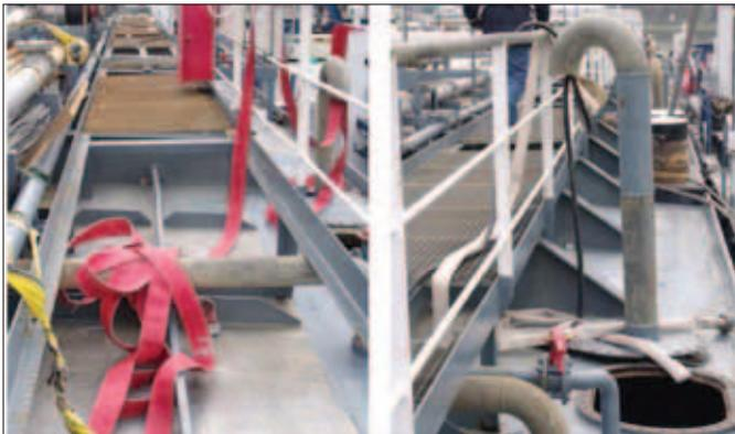
Abb. 12: Feuerwehrschauch und Kabel in Belüftungsleitungen von Ballasttank 5 [Fotos aus 1]
