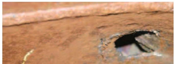
Abb. 11: Löcher in der BB-Kimm von Tank 5 [Fotos aus 1]
