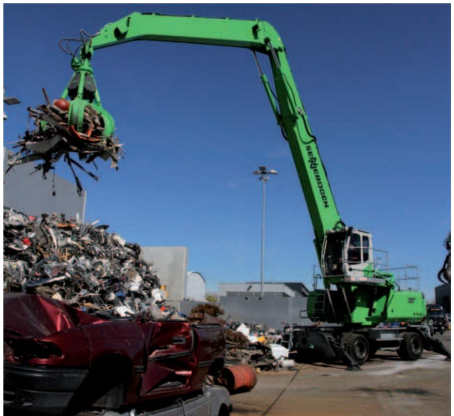
Im Einsatz beim Schrottschlag offenbart der Sennebogen 835 E seine Stärken. Kraftvoll bewegt er mit dem Mehrschalengreifer große Schrottmengen und bleibt selbst bei höchster Belastung dauerhaft sparsam. Foto: Sennebogen
